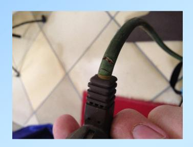
defekter Knickschutz und defekte Anschlussleitung eines Heizstrahlers
