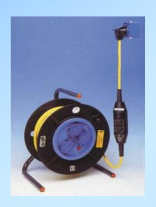
Leitungsroller (Kabeltrommel) der Anwendungskategorie mit hochempfindlicher Fehlerstrom-Schutzeinrichtung (PRCD-S) in der Anschlussleitung. Dadurch ist ein zwangsläufiger Zusatzschutz gewährleistet.
